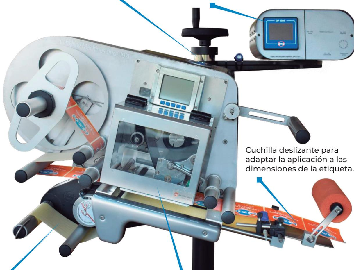
Cuchilla deslizante para adaptar la aplicación a las dimensiones de la etiqueta.
